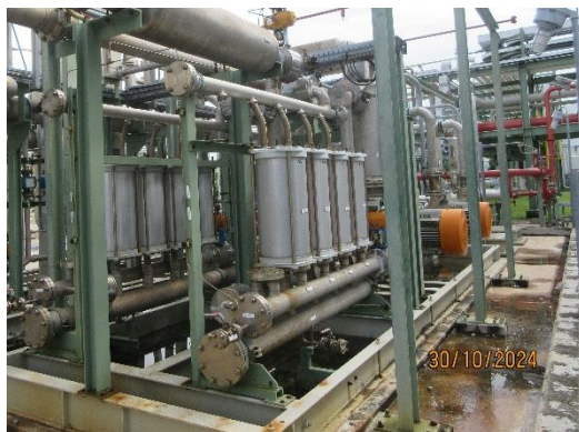
ภาพที่ 2-11 ระบบกรองอากาศแบบ Membrane ของหน่วยแยกไอระเหย (VRU)
