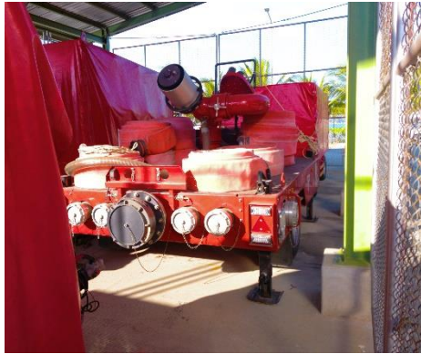
ภาพที่ 2-58 ติดตั้งปั้มน้ำดับเพลิง
